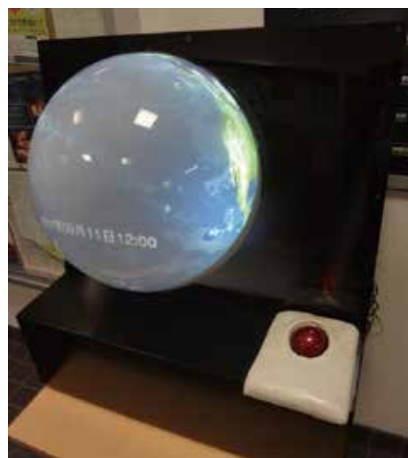
超短焦点プロジェクターが中に入った背面投影 40cm アクリル半球スクリーン箱とトラックボール
