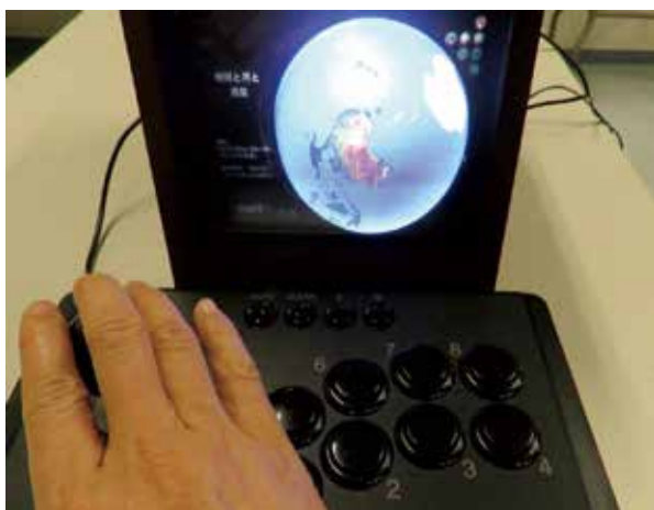
小型プロジェクターが中に入った背面投影 12cm アクリル半球スクリーン箱とジョイスティック
